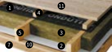
Чердачное перекрытие (вид со стороны чердака)
