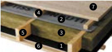
Цокольное перекрытие (вид со стороны тёплого помещения)
