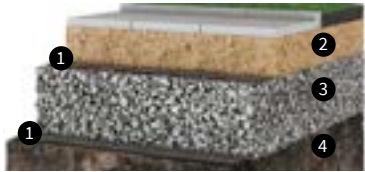
Разделение слоёв грунта при обустройстве площадок и садовых дорожек
