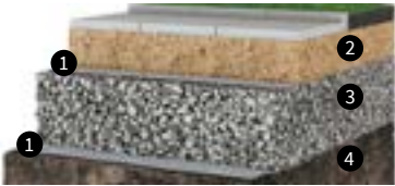
Разделение слоёв в дорожном строительстве, при сооружении парковок, устройстве инверсионных кровель и садовых дорожек
