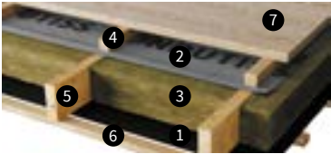
Цокольное перекрытие (вид со стороны тёплого помещения)
