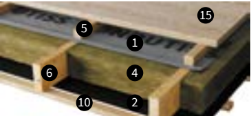
Цокольное перекрытие (вид со стороны тёплого помещения)
