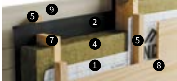
Каркасная стена (вид изнутри)
